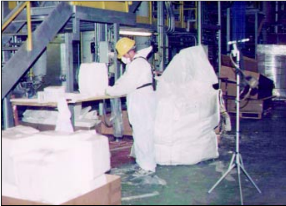
Figure 9: Rifinitura dei blocchi di fibra per la coibentazione di un forno
